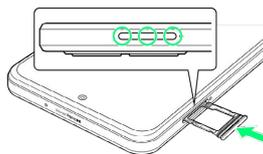
🏁 USIMカードの取り付けが完了します。
