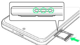
🔲 USIMカードの取り外しが完了します。
