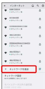
・ 「ネットワークを追加」のアイコンをタップすると、QRコードのスクリーン画面が表示されます。QRコードを読み取ると、パスワードが共有され、Wi-Fiネットワークに接続することができます。
